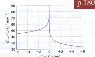
図 4B-10 ヘリウムの  $\lambda$  転移、この点で、熱容量は無限大に発散する。 $\lambda$  転移の名前は、この曲線のかたちに由来する。
