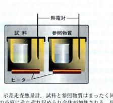
図 2C-3 示差走査熱量計。試料と参照物質はまったく同じつくりの小室にそれぞれ入れられ全体が加熱される。出力されるのは、昇温したとき両方の小室の温度を等しく保つのに必要な電力の差である。
