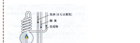
図 2A-9 断熱型定圧フレーム熱量計は、この装置を操作するときの水槽に入れるものである。既知量の試薬を燃料として炎に送り込んで燃焼させ、温度上昇を測定する。
