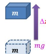
質量  $m$  の物体を重力に逆らって  $\Delta z$  の距離持ち上げるときの仕事
