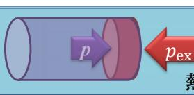
④断熱変化 (Adiabatic Process) 热の出入りがない 断热材で覆った系
