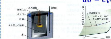
図 2A-8 系の内部エネルギーは体積と温度によって変化する。各分子は個々の曲線で示される。また、ある体積があったときの内部エネルギーが  $U$  でなければならぬ。断熱性を保証するために熱量計は水槽に沈められている。燃焼が起こって熱量計の温度が変わると、水槽の水の温度も熱量計と同じ温度になるよう調整される。
